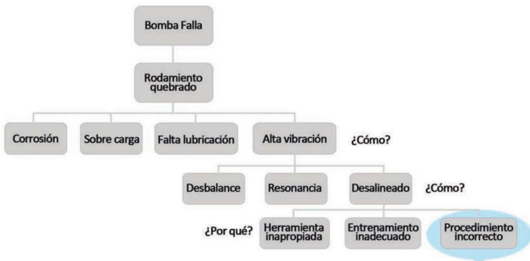
CAUSA-RAÍZ DE LA FALLA
