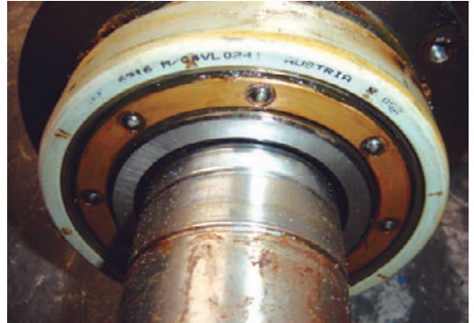
Figura 6. Rodamiento aislado para combatir fenómeno de corrientes en rodamientos.
